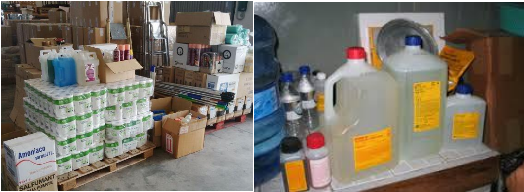
Mal almacenamiento de sustancias peligrosas ácidos y bases juntas
