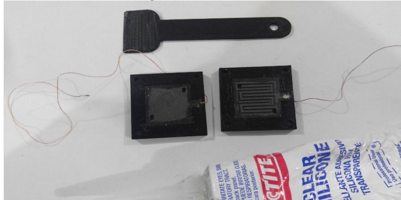
Fig. 38. Sello de posibles fugas de gas con ayuda de silicona en el ensamble de la figura anterior.
