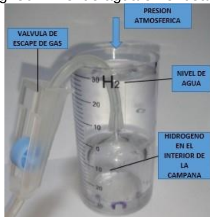
Fig. 50. Nivel de agua en el beaker.
