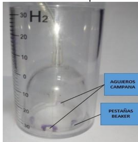
Fig. 48. Correcto ensamble de la campana en el interior del beaker.
