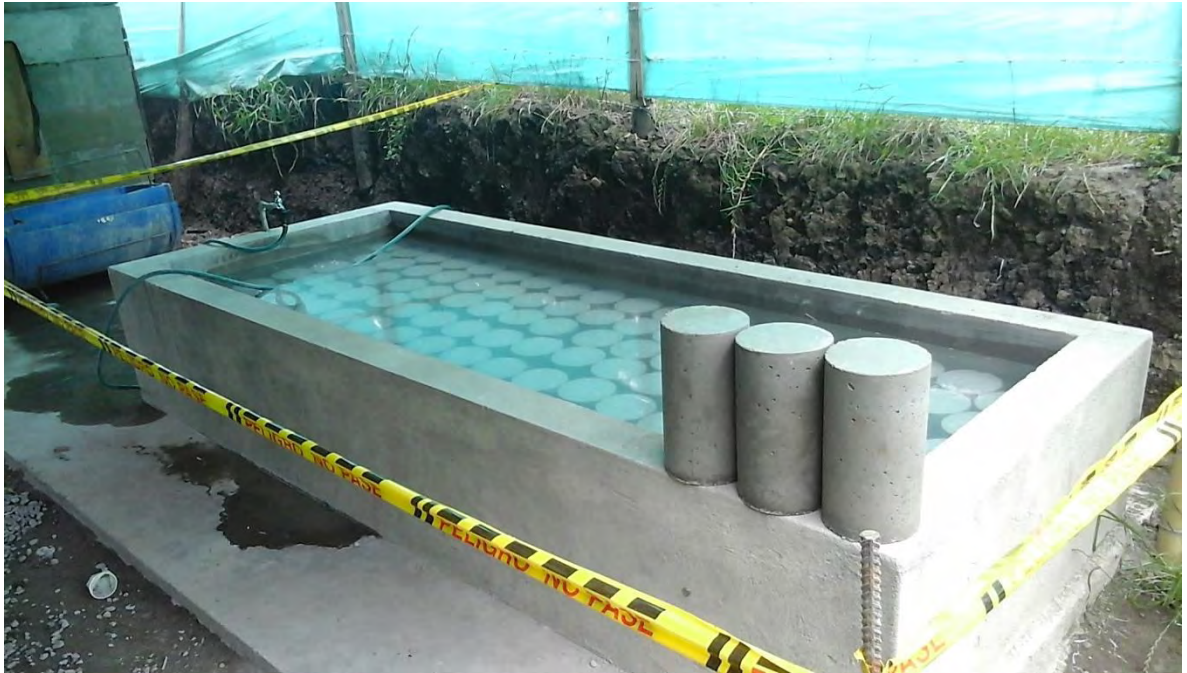
Figura 20. POSETA DE CURADO MUESTRAS DE CONCRETO
