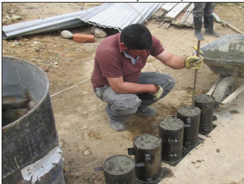
Figura 51 - Toma de muestras de ensayos de compresión del concreto.
