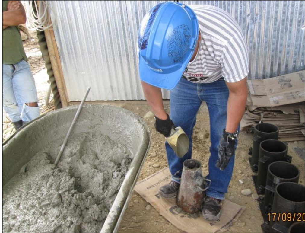
Figura 30 - Ensayo de Consistencia del concreto (slump).
