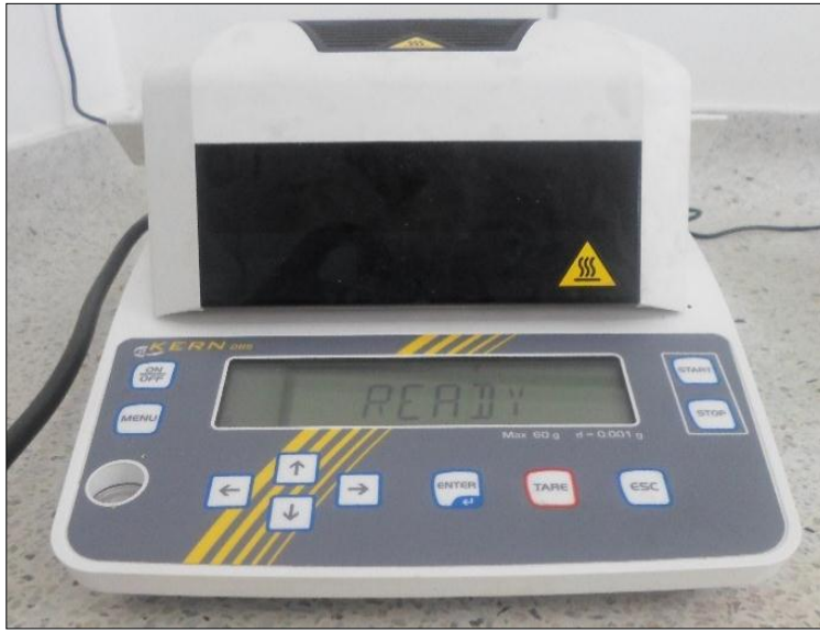
Figura 13. Determinación de Humedad. Equipo KERN DBS.
