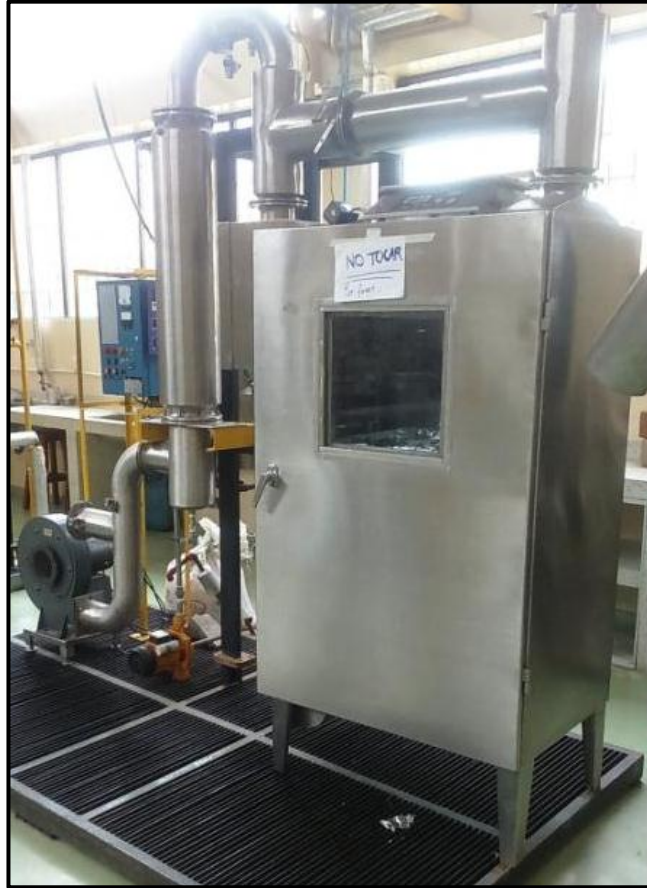
Figura 12. Secado de almidón en Unidad de secado y humidificación FIC.
