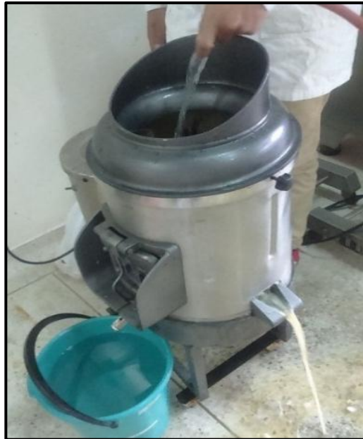
Figura 8. Peladora de tubérculos marca COMEK.
