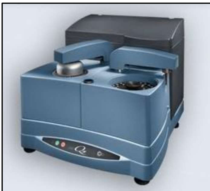
Figura 24. Calorímetro de Barrido Diferencial (DSC) TA Instruments, modelo Q20.
